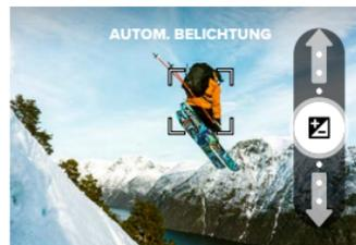
Schiebe den Schieberegler nach oben, um das Bild aufzuhellen. Schiebe ihn nach unten zum Abdunkeln. Du kannst bis zu zwei Stufen in beide Richtungen einstellen.
